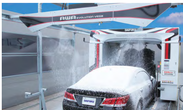
泡洗車システム「AWAエボリューション ベガ」を装備したドライブスルー洗車機「ファブリカ」
